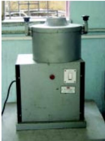
**FIG. 20 : CENTRIFUGE EXTRACTOR**
