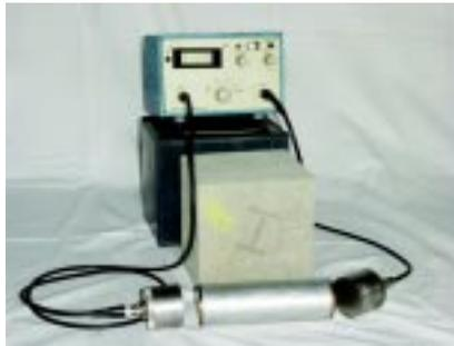
**FIG. 12 : ULTRASONIC PULSE VELOCITY METER**
