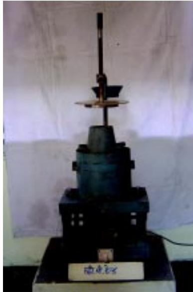
**FIG. 10 : VEE-BEE CONSISTOMETER**
