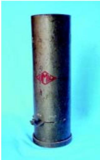
**FIG. 19 : SAND-POURING CYLINDER**
