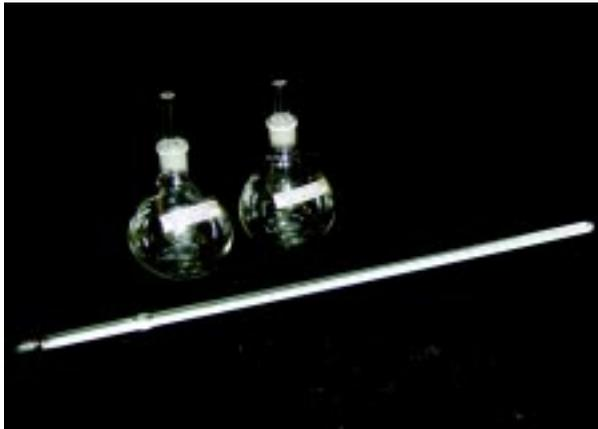
**FIG. 21 : SPECIFIC GRAVITY BOTTLES**
