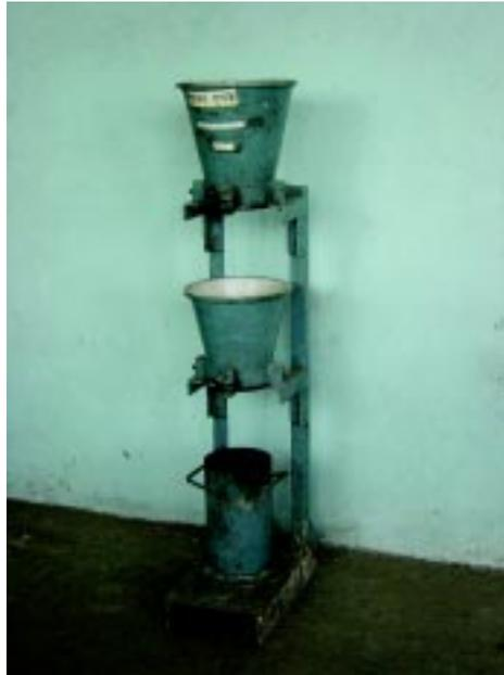
**FIG. 9 : COMPACTING FACTOR APPARATUS**
