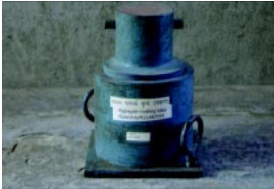
**FIG. 7 : CYLINDRICAL MEASURE AND PLUNGER**
