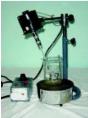
**FIG. 25 : RING AND BALL APPARATUS**
