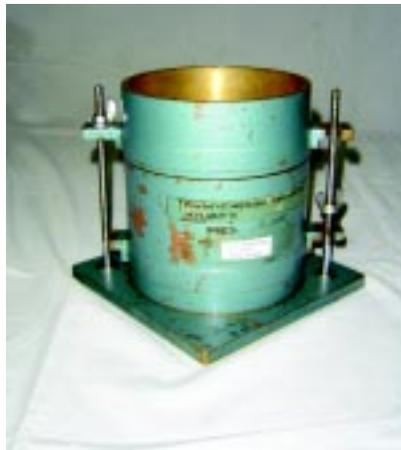
**FIG. 17 : CYLINDRICAL METAL MOULD**
