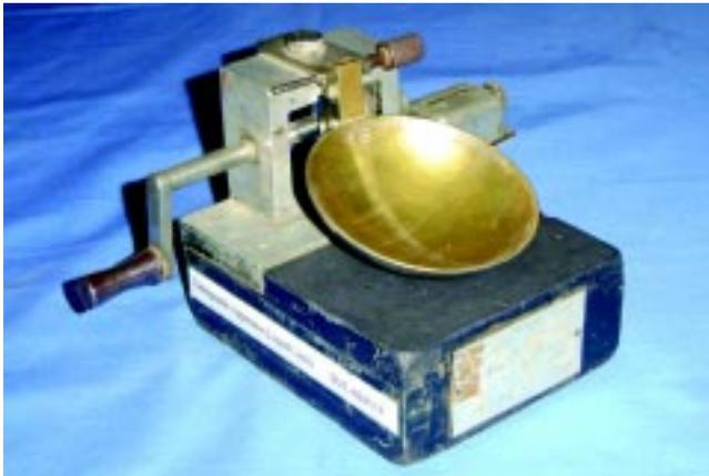
**FIG. 16 : CASAGRANDE'S LIQUID LIMIT DEVICE**
