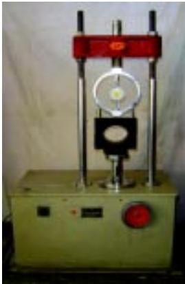
**FIG. 22 : MARSHALL STABILITY APPARATUS**
