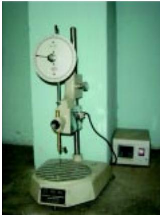
**FIG. 23 : PENETROMETER**
