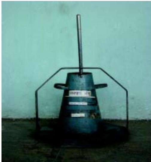
**FIG. 8 : SLUMP CONE**
