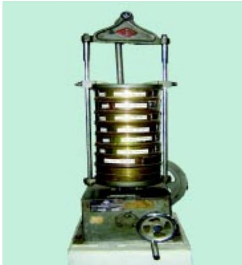
**FIG. 4 : A SET OF IS SIEVES**
